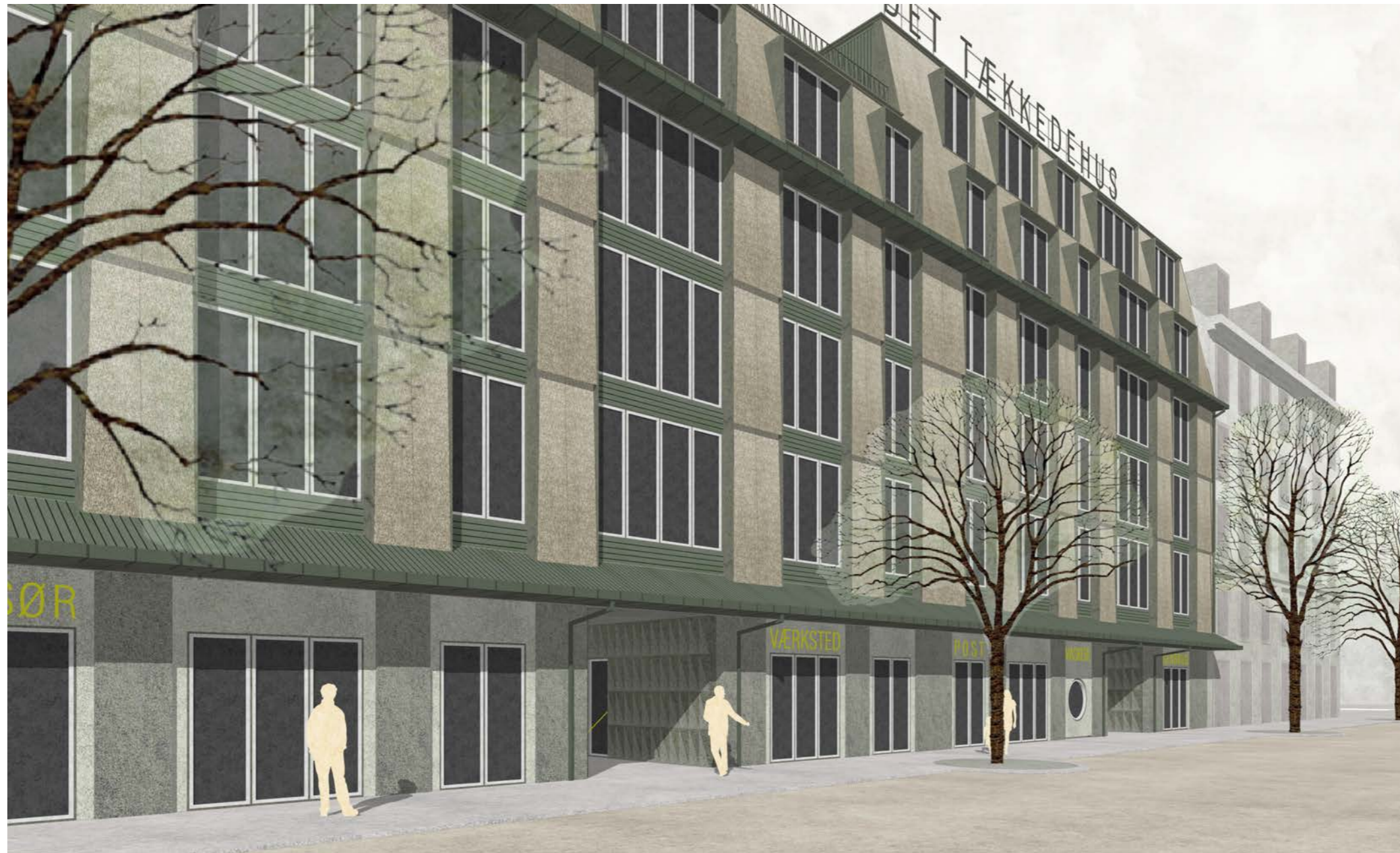
FACADESTUDIE - PUDSET BASE - GESIMSBÅND OG UDHÆNG SKABER KONSTRUKTIV BESKYTTELSE - STUEETAGEAREAL REDUCERET MED ÅBNE PASSAGER, PORTE EL. LIGN.
