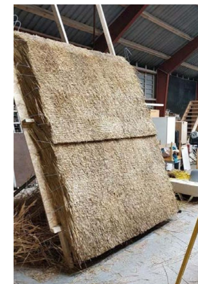
TÆKKET ELEMENT - PRØVE TIL PAVILLON UDFØRT AF TÆKKEMANDEN HORNEBY / THOMAS GERNER
